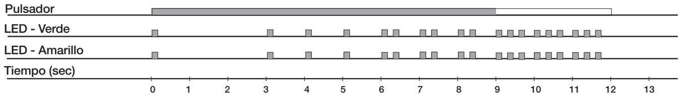
Al desactivar el pulsador después de 12 seg., el sensor volverá al ajuste de fábrica.
